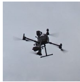
上空に飛び立つドローン。赤外線カメラによる夜間検知で鳥獣の行動範囲を可視化し、スピーカー搭載ドローンで効率的な鳥獣被害対策を実現します。
