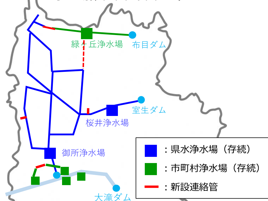
浄水場配置図（集約後）
