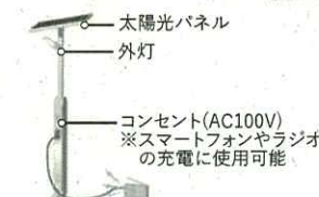
⑤コンセント付ソーラー外灯
