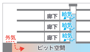
〔クール・ヒートトレンチ〕
