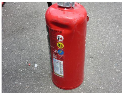
・容器などに大きなキズや変形した箇所がある消火器
