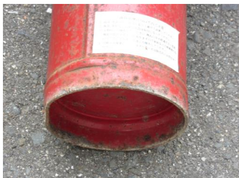
・ひどく錆びている消火器
