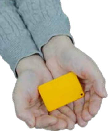
登下校見守りサービスに使われるICタグ。6cm×4cmと手のひらサイズです。
