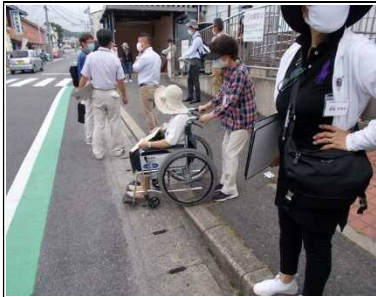
西口は、道路との間に高低差があり、全体的に勾配がきつい。
