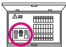
分電盤に内蔵されたセンサーが揺れを感じ、ブレーカーを落として電気を遮断
