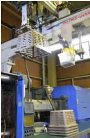
出来上がった製品は自動で取り出されます。1台の機械で全ての製造工程を対応
