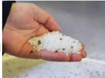
透明樹脂に茶色の色粉を混ぜたものを250℃の高温で溶かします
