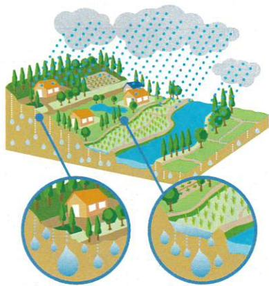
雨水を地中にたくわえる 雨水を水田にたくわえる
