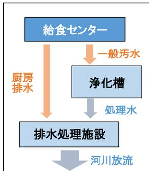
図5. 排水処理のフロー
