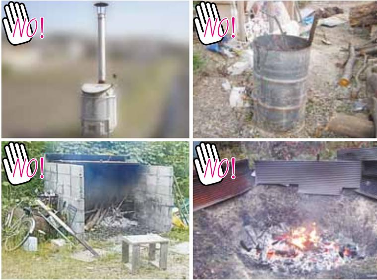
使用が禁止されている焼却炉。簡易な焼却炉(左上)、ドラム缶(右上)、ブロックやコンクリートなどで囲った焼却炉(左下)、直火の焼却炉(右下)
