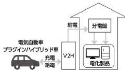
図表 19 V2H システムの仕組み
