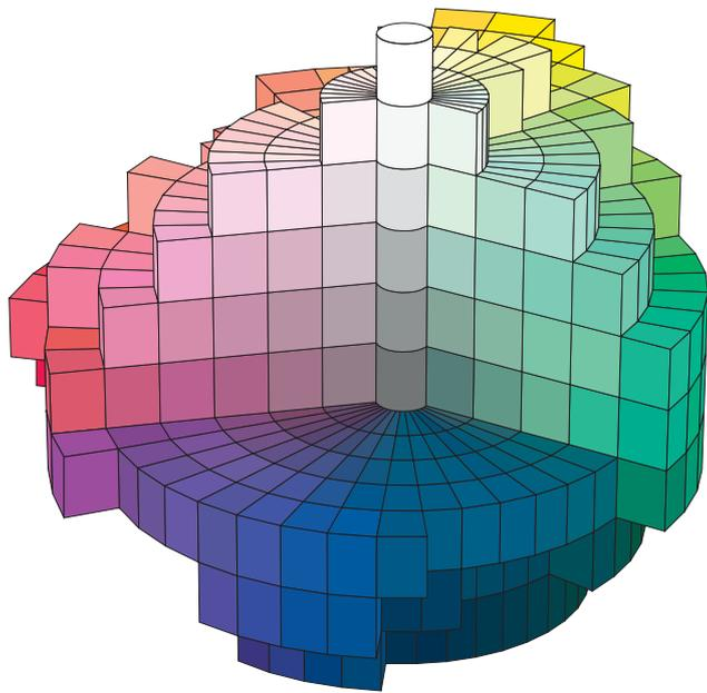
■ 図 マンセル色立体の構造
