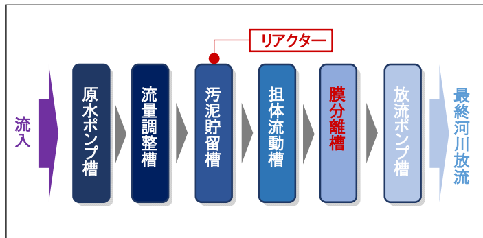
図6. 排水処理施設フロー
